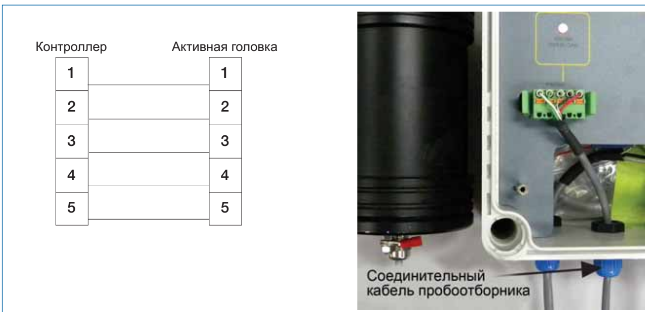
Рис 9: Соединение между активной головкой и контрольным щитом
