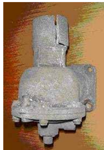
图 6. 现场环境腐蚀性严重，脉冲阀受破坏
